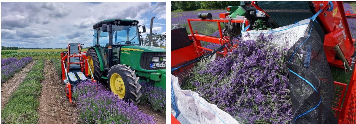
Abbildung 2: Lavendelernte mit halbautomatischem Anbaugerät
