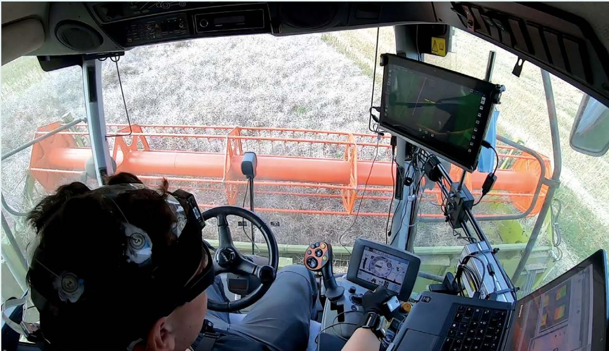
Daten sammeln auf dem Mähdrescher: Messungen während der Ernteperiode zu Projektbeginn des Konsortiums Fahrerkabine 4.0. Es wurden Eye-Tracking-Systeme und Pulsmessverfahren genutzt, die die Erkennung des Beanspruchungszustands der Nutzenden zuverlässig aufzeigen.
