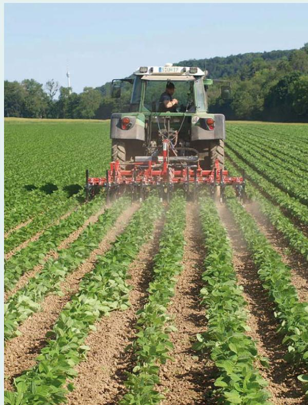
Sensor- und kameragesteuerte Hacke zur Unkrautbekämpfung im Feldversuch Sojaanbau an der Universität Hohenheim
