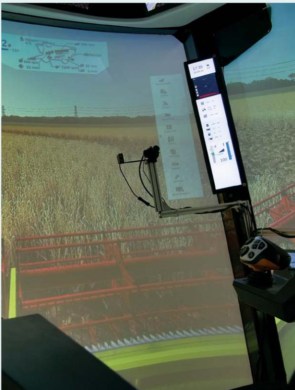
Erster Betrieb der Demonstratorkabine mit der Umgebungssimulation auf den Scheiben und mit eingebauter Zustandserfassung
