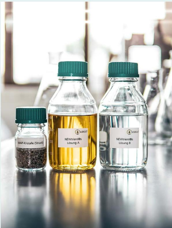
SUSKULT-Flüssigdüngerkonzentrat (A- und B-Lösung, Mitte und rechts) im Vergleich zu schwer wasserlöslichen Rezyklaten
