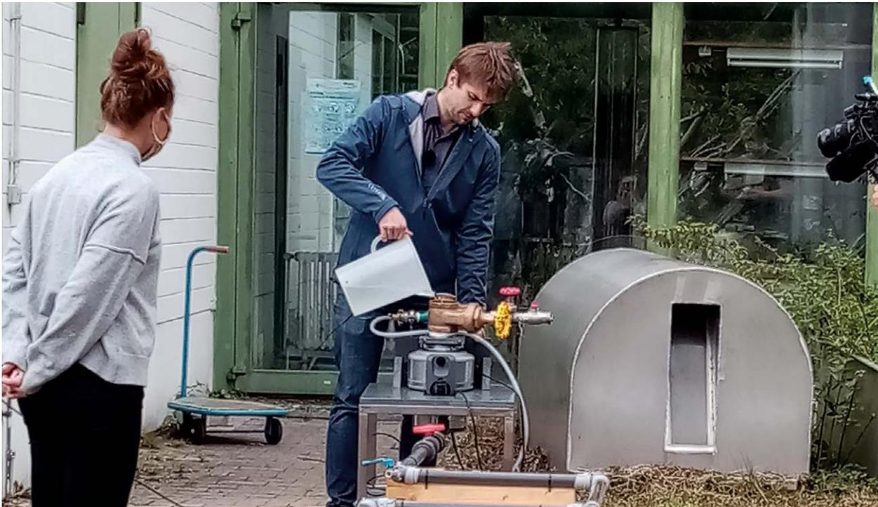
Küchenabfälle sind eine zentrale Ressource für die Kreislaufschließung im Forschungsprojekt RUN. Hier wird der Prototyp des für Spülbecken vorgesehenen Küchenabfallzerkleinerers und der Abtransport mit einem wassersparenden Unterdruck-Rohrsystem getestet.
