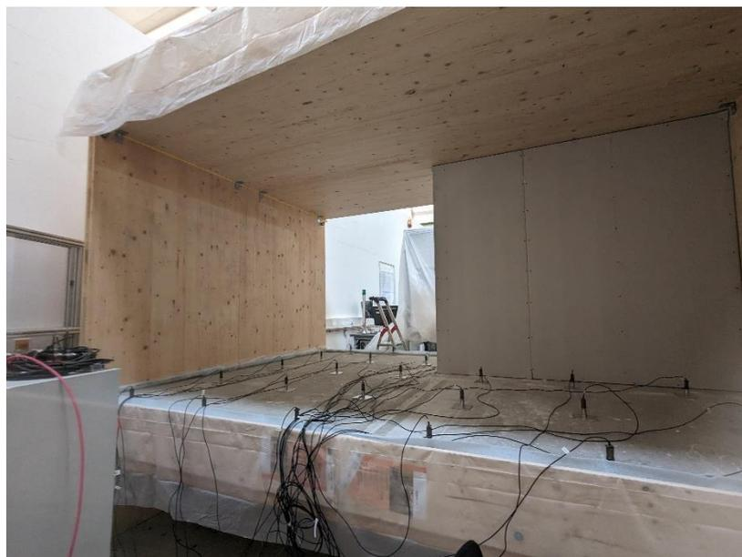
Abbildung 32: Variante 12b mit Trockenbauwand – Sensoren auf Estrich platziert
