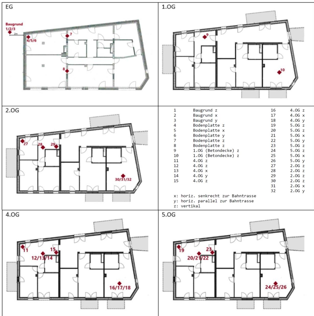
Abbildung 7: Messstellen und Messkanäle im Gebäudeabschnitt W, Messobjekt B
