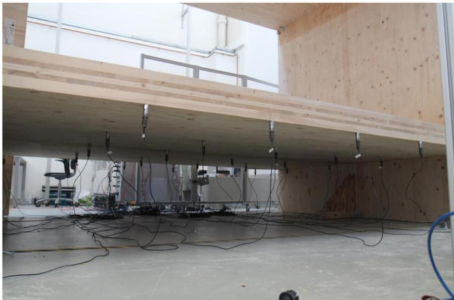
Abbildung 28: Instrumentierung auf der Unterseite der BSP mit 30 Beschleunigungssensoren
