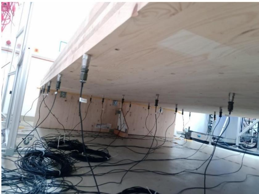
Abbildung 30: Variante 4b – Winkelverbindung, Decke mit Akustiklager (gelb) unten, Stufenfalz verschraubt
